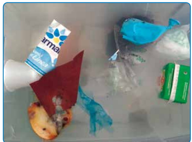
Figura 86 – Esperimenti per testare i tempi di degradazione di diverse macro-categorie di rifiuti marini
