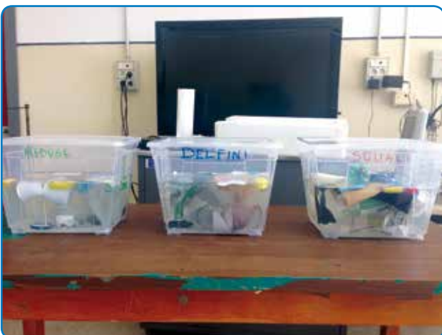
Figura 86 – Esperimenti per testare i tempi di degradazione di diverse macro-categorie di rifiuti marini
